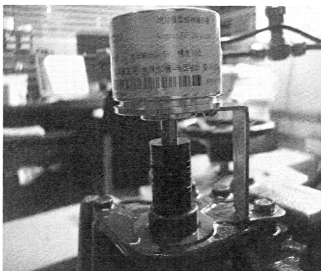
图 3-10 绝对值编码器安装局部图
