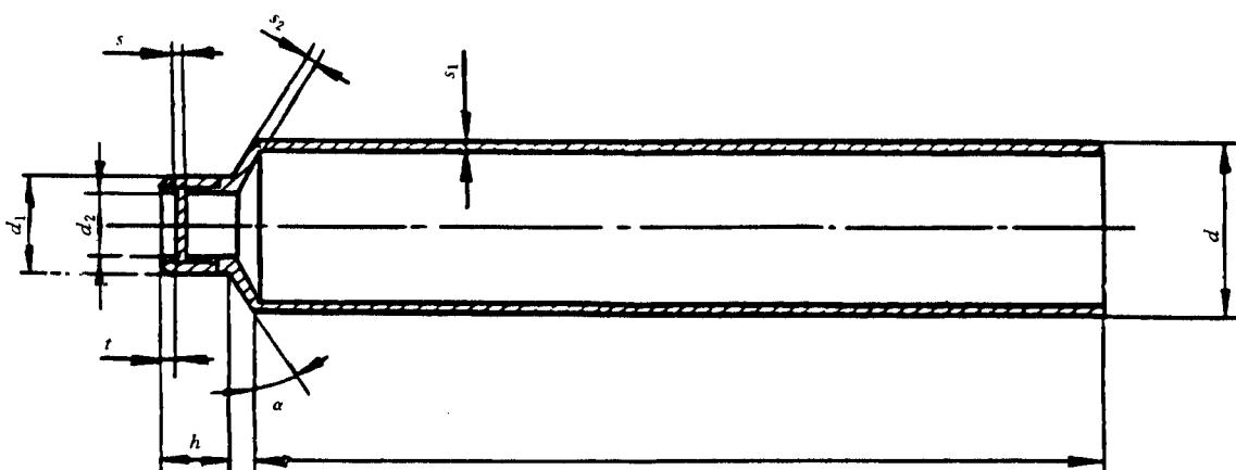
$d$ —直径;  $d_1$ —口外径;  $d_2$ —口内径;  $s$ —薄顶厚度;  $s_1$ —壁厚;
