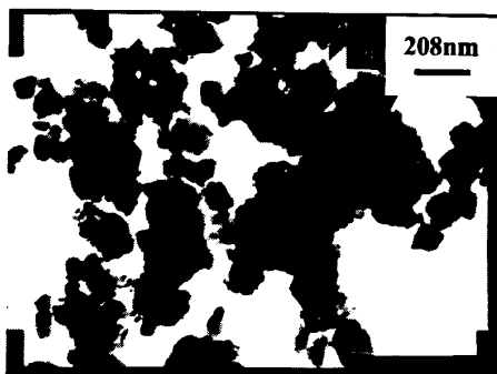
图 3-2 经 800℃焙烧后的非负载型过渡金属纳米催化剂的 TEM 照片 氨水添加量：200ml，有机相添加量：0 ml
