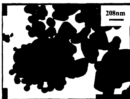
图 4-2 经 1200℃ 焙烧 2h 后得到的负载型过渡金属纳米催化剂的 TEM 照片 有机相添加量：10.8ml，载体添加量：15.5g
