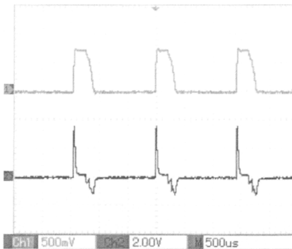
图 6.8 负载时电源输出波形 (600Hz,30%,1:1)
