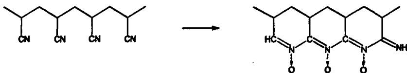
图 1-4 氧以氮氧化物化合物形式在纤维上的结合
