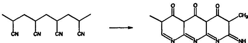
图 1-6 氧以羰基的形式在纤维上的结合
