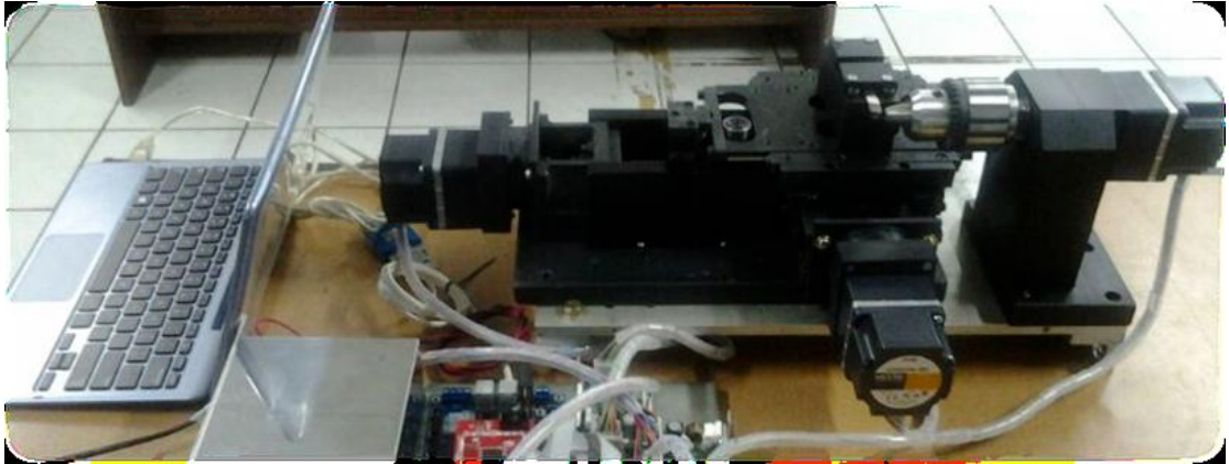
图 6. 数控车床完整的技术原型
