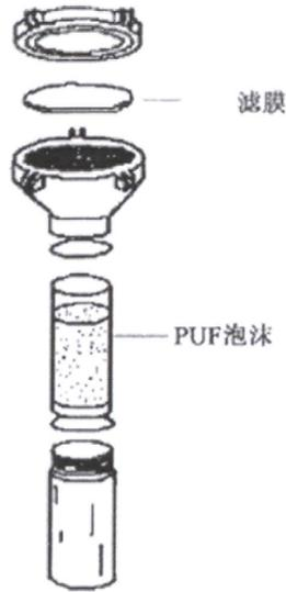
图 3.3 PUF 主动采样器示意图
