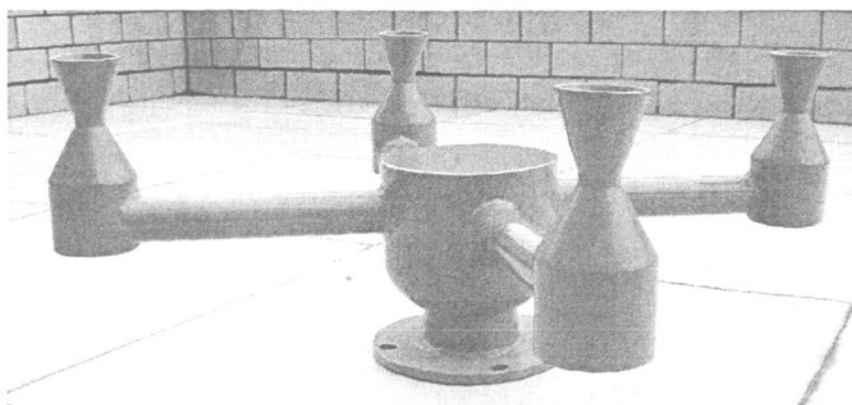
图 5-2 雾化装置模型三维图
