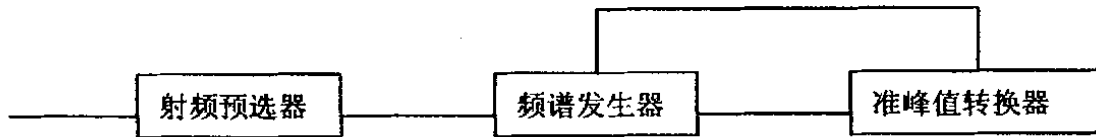
图 4-4 频谱分析仪/电磁干扰接收机组成
