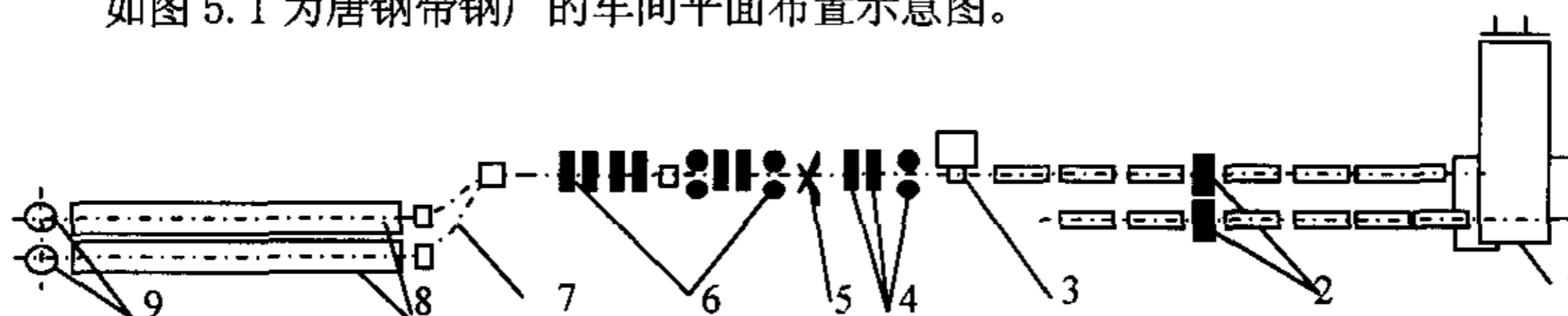
图 5.1 唐钢带钢厂车间平面布置示意图
