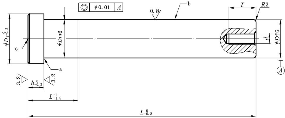
未注表面粗糙度  $R_a = 6.3 \mu\text{m}$ ; 未注倒角  $1 \text{ mm} \times 45^\circ$ 。
