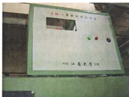
图 2-5 电气控制系统
