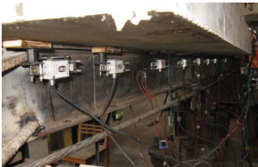
c. 位移计、导杆仪布置示意图与实物图
