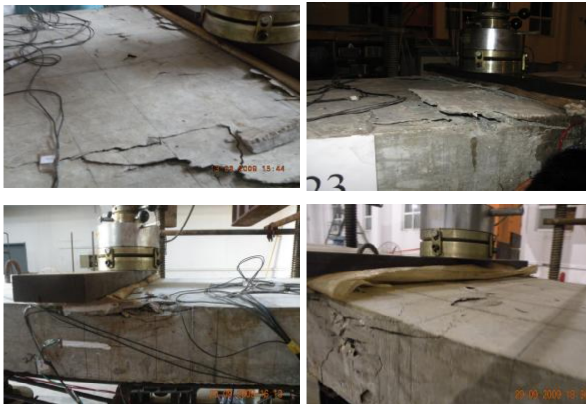
a. 加载点处混凝土的压碎
