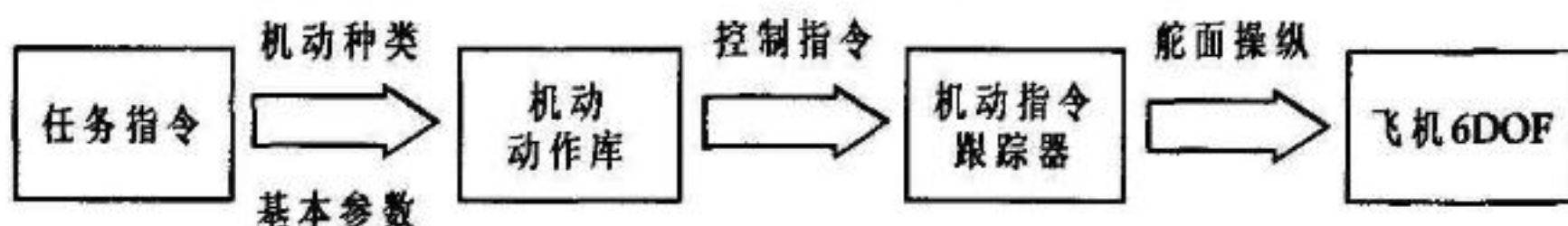
图 2-1 自动飞行仿真系统总体框架图
