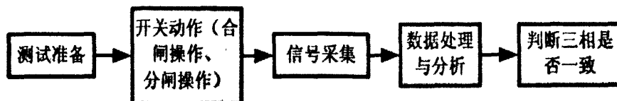
图 3-4 三相同期性测试步骤图
