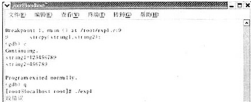
图 7-1 字符串数组越界的源程序在 Linux 下运行结果
