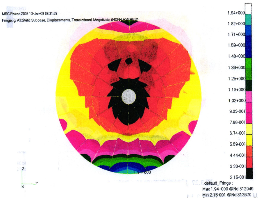
图 3.25 反射面变形(F15°, P0°, G+W12.5m/s 正吹)
