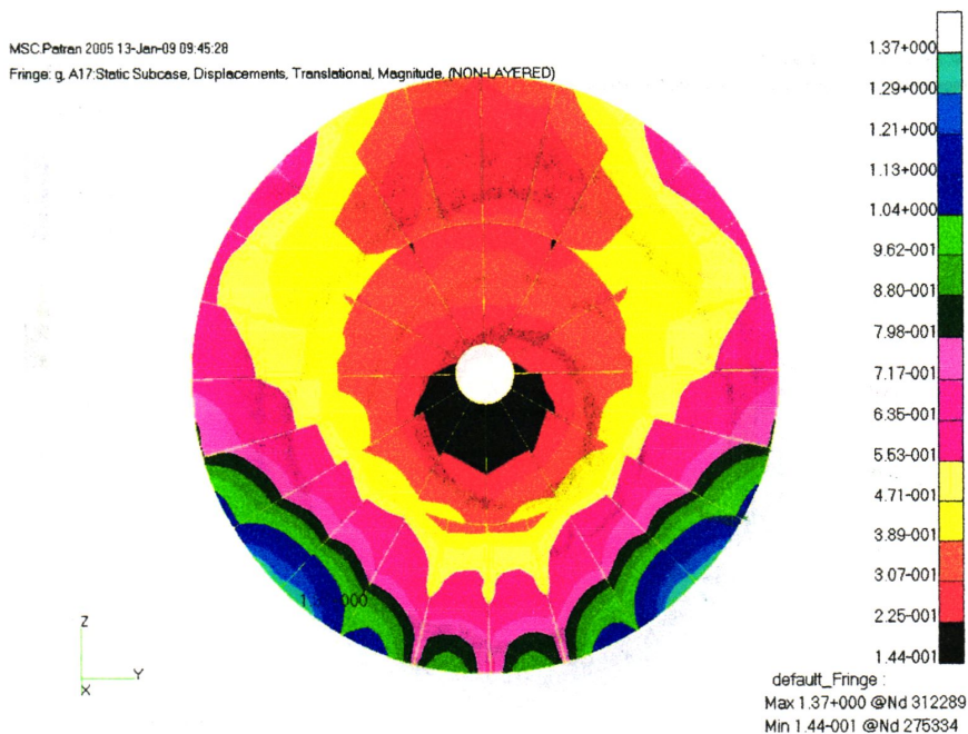
图 3.20 反射面变形(F15° ,P45° ,G)
