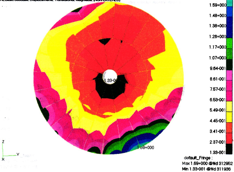
图 3.19 反射面变形(F15°, P22.5°, G)
