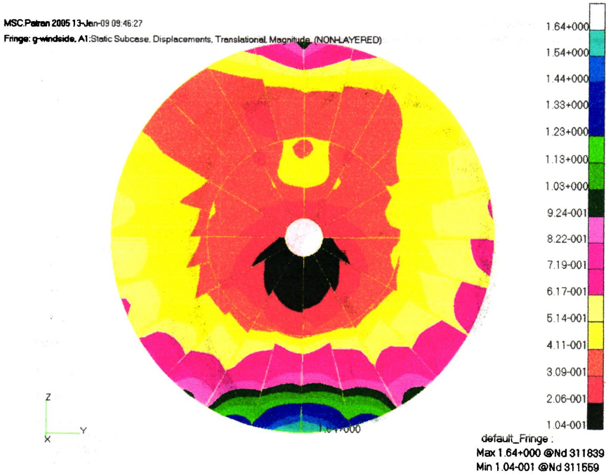
图 3.26 反射面变形(F15° , P0° , G+W12.5m/s 侧吹)
