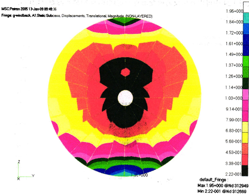
图 3.27 反射面变形(F15° , P0° , G+W12.5m/s 背吹)
