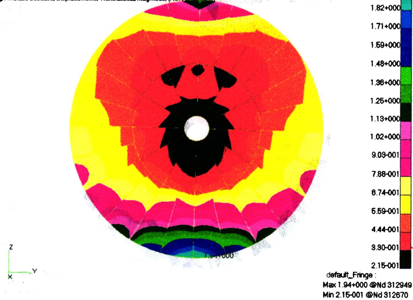
图 3.18 反射面变形(F15°, P0°, G)
