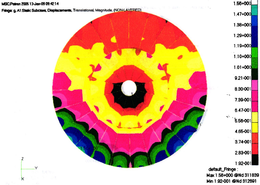
图 3.17 反射面变形(F45°, P45°, G)
