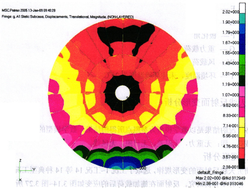
图 3.15 反射面变形(F45°, P0°, G)
