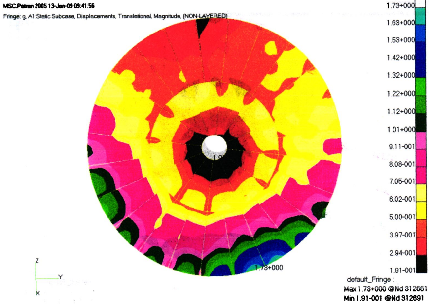
图 3.16 反射面变形(F45°, P22.5°, G)
