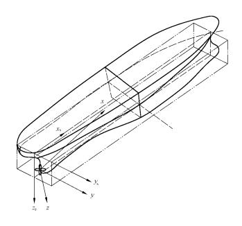
注:图中标有下标 s 的坐标为船舶坐标(与 ITTC 的相关规定不一致,但 ITTC 表示认可)。
