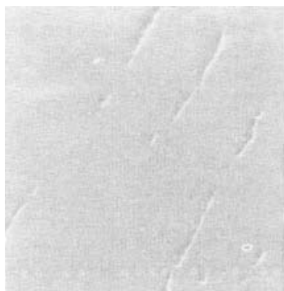
图 3-5 夹杂物的二次电子像
