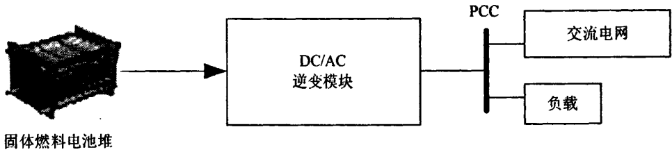
图 2.2 固体燃料电池发电系统供电模式
