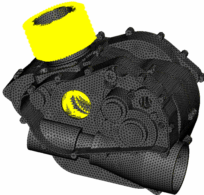
图 5.4 下止点时刻载荷示意图
