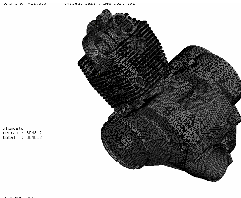
图 4.3 发动机壳体有限元模型
