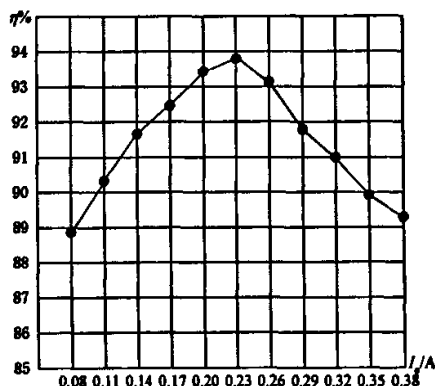
图 6.4 变换器的效率曲线
