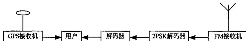
图 4-2 车载调频副载波接收装置结构图
