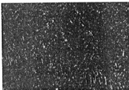
图 3-2-12、双合金经 30%变形、热处理制度（II）后焊缝中心高倍组织
