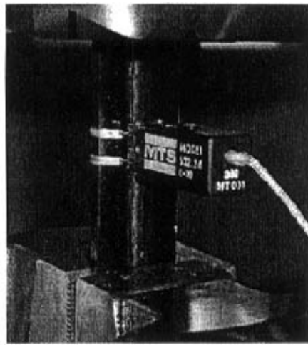
图 5-7 夹持在试样上的应变测量传感器 Fig.5-7 strain sensor on the sample
