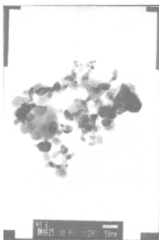
图 3-16 银修饰纳米氧化锌 (单位长度：50nm)
