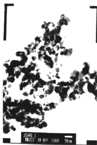
图 2-14 纳米氧化锌的电镜形貌 (单位长度：50nm)
