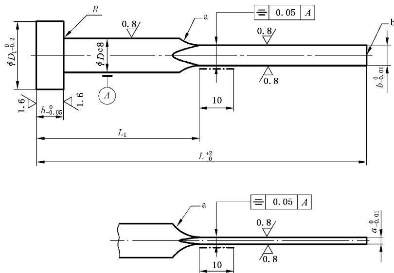
未注表面粗糙度  $R_a = 6.3 \mu\text{m}$ 。
