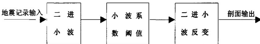
图 3-1 小波变换阈值去噪方框图
