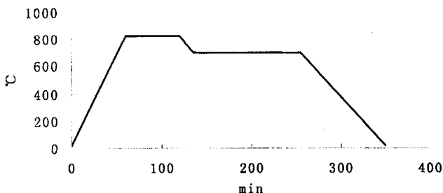
图 3-4 水雾化高速钢粉末的退火
