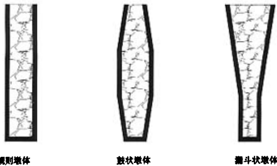
图 3.2-4 强夯碎石墩复合地基墩体简图
