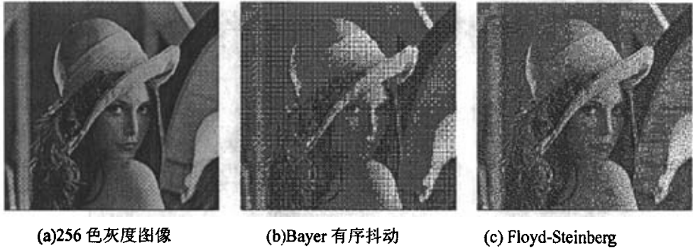
图 4.2 抖动算法与误差扩散算法的处理效果对比
