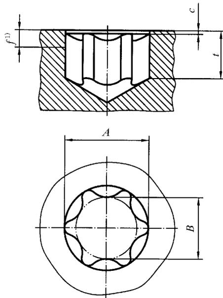
沉孔:  $c \leq 0.13 \text{ mm}$ , 对槽号  $\leq \text{No. 15}$ ;
