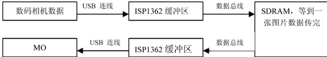
图 5-10 USB 设备连接标准数据流程
