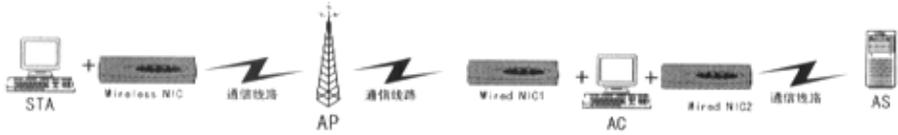
图 4-1 安全无线局域网构成图
