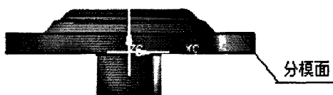
图 3-2 上下模具设计中锻件的分模面
