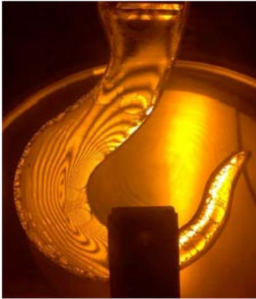
图 3. 钠光下的应力光弹性模式
