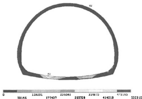
图 4.14 二次衬砌拉应力图 (Pa)
