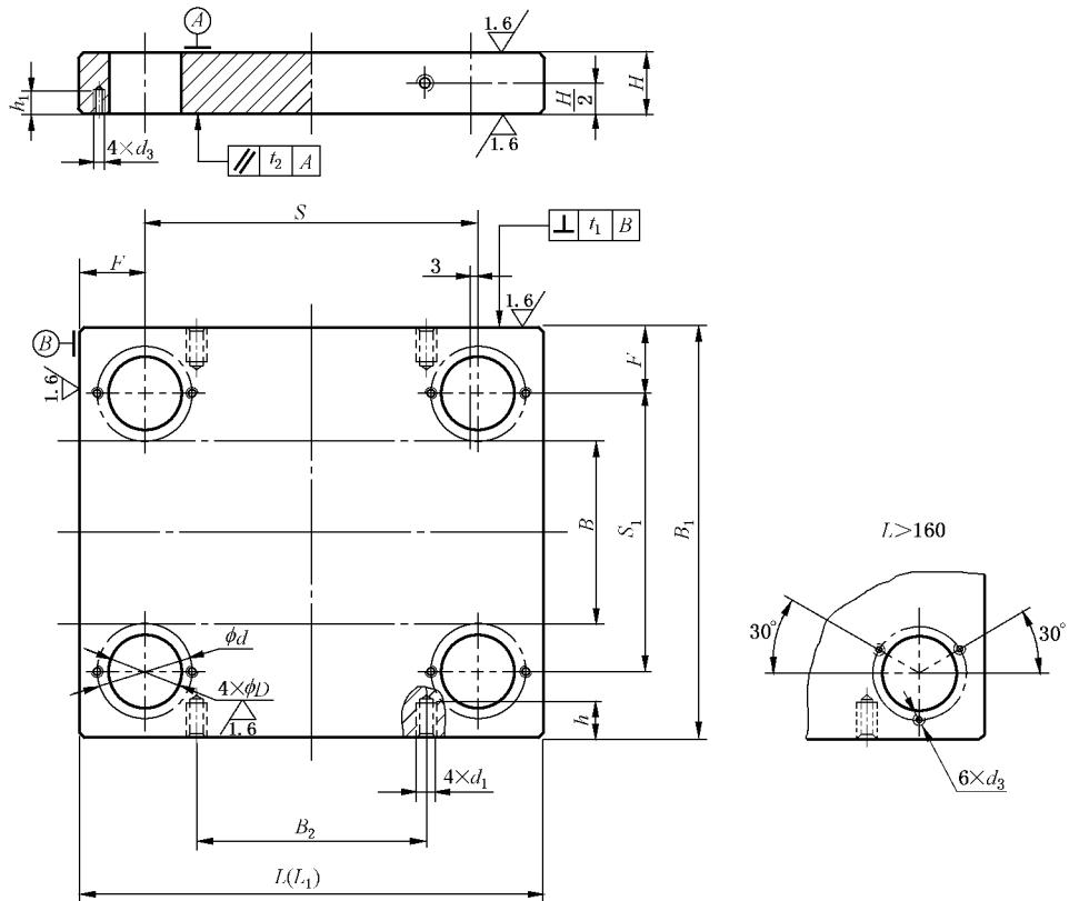
注：未注表面粗糙度  $R_a 6.3 \mu\text{m}$ 。
