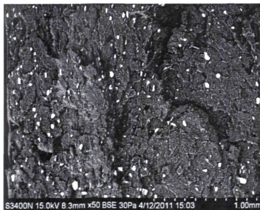
(b) 拉伸强度最差的断面形貌 x50
