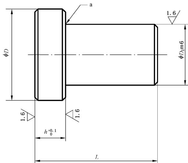
未注表面粗糙度  $Ra=6.3\ \mu\text{m}$ ;未注倒角  $1\text{mm}\times 45^\circ$ 。
