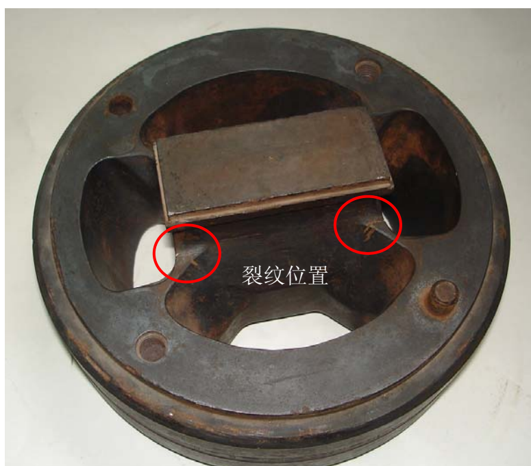
图 4-12 模具出现裂纹的位置（实物照片）
