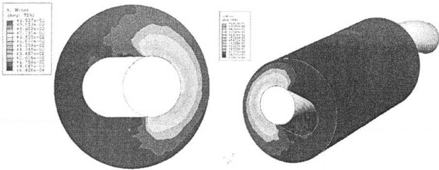
图 4.3.1. (b) t=0.2s 时刻转子的位置和定子的 mises 应力分布图
