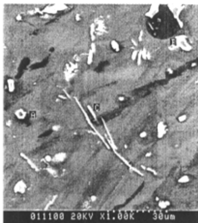
图 3-6 S3 合金铸态 SEM 组织与能谱分析 Fig. 3-6 Microstructure of as-cast S3 alloy
