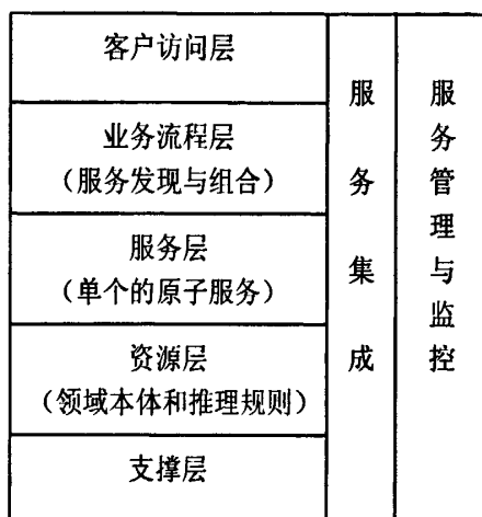
图 5.1 网络制造环境中的网络资源的抽取建模层次
