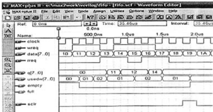
图3-22 FIFO模块仿真图
