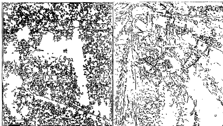
图 5-2 \sigma=0.5 的高斯小波 ( 0 \leq j \leq 5 , 尺度 j ) + 中值滤波 + Canny 算子
