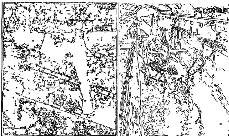
图 5-4 \sigma=0.5 的高斯小波 ( 0 \leq j \leq 5 , 尺度 j ) + 中值滤波 + 梯度相位法
