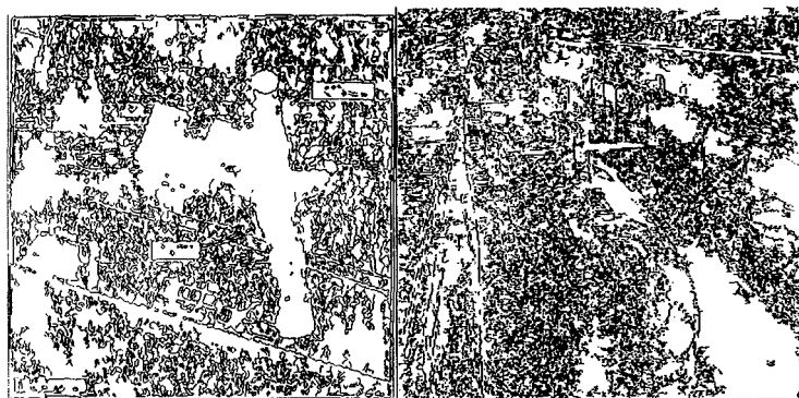
图 5-1 二次样条小波 ( 0 \leq j \leq 2 , 尺度 j ) + 中值滤波+Canny 算子
