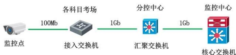
网络采用三层结构，前端采用接入交换机，中心设置汇聚交换机和核心交换机。前端监控点到接入交换机的带宽为 100Mbps，接入交换机到汇聚，汇聚到核心交换机的带宽为 1Gbps，保证音视频传输的质量和效果。
