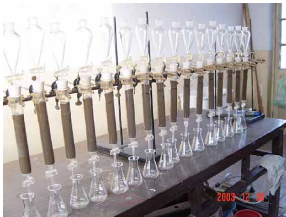
图 3-1 缓/控释肥在土壤中淋洗试验装置图
