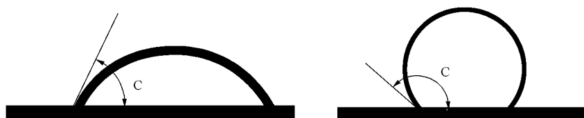
图 1 接触角示意图
