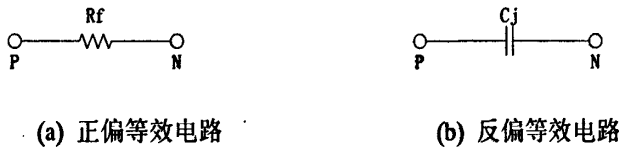
图 4.4 PIN 二极管正、反偏等效简化电路
